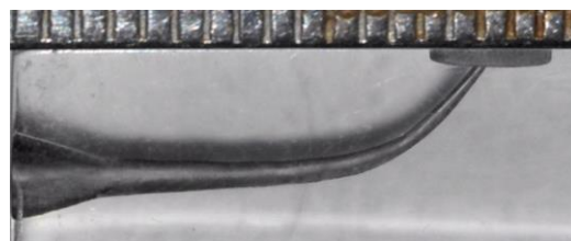
Figura 1.- Bloque plástico con conducto curvo simulado, instrumentado con la lima WOG Primary
